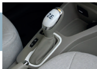
Levier de vitesse en position «P»
